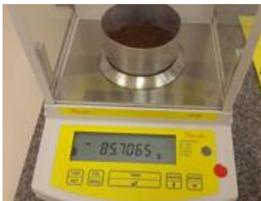
Figura 6 – Pesaje de muestras en balanza de precisión
