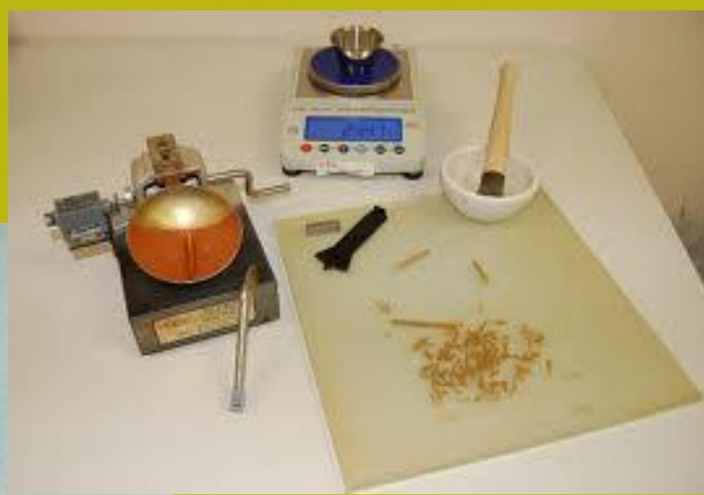
Para obtener el limite Plástico LP se toma una **cantidad aproximada de 20 gr de suelo umedo**. Se amasa con la mano procurando que la humedad sea uniforme y se rueda hasta formar un cilindro uniforme de 3 mm de diámetro. Se continua a rollarlo hasta che no empiezan a formarse grietas. **Esta condición es el limite Plástico LP.**
