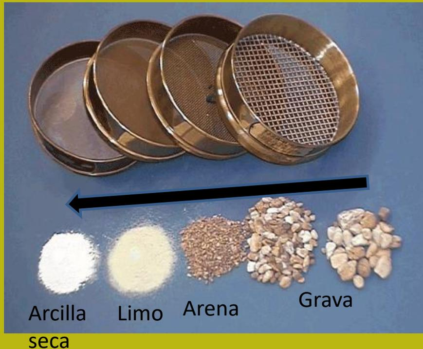
**Tamices de laboratorio para el análisis de la distribución de tamaño de grano.** Muestra (de derecha a izquierda) son los números tamiz. 3/8-pulg. (9,5 mm), N ° 10 (2,0 mm), N ° 40 (250 micrón) y N ° 200 (75 micrón) y los tamaños de las partículas del suelo Incluyendo ejemplo (de derecha a izquierda): **grava medio, grava fina, medio-grueso de arena, limo, polvo de arcilla seca.**
