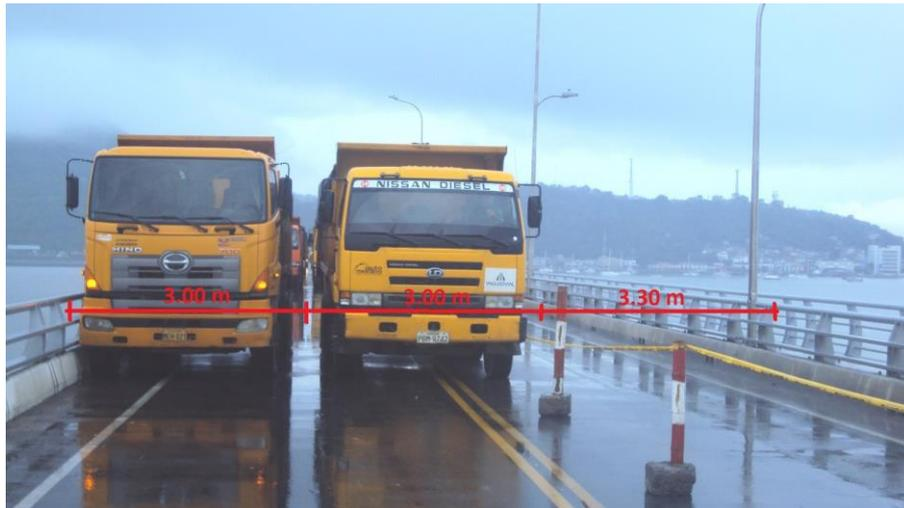
**Fig. 6.4:** *Dimensiones referenciales en la prueba de carga del Puente Los Caras, con camiones estáticos*
