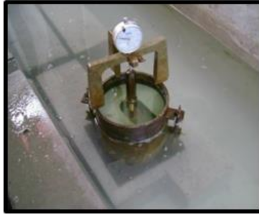
Imagen 41 Inmersión de molde y colocación de trípode con deformimetro
