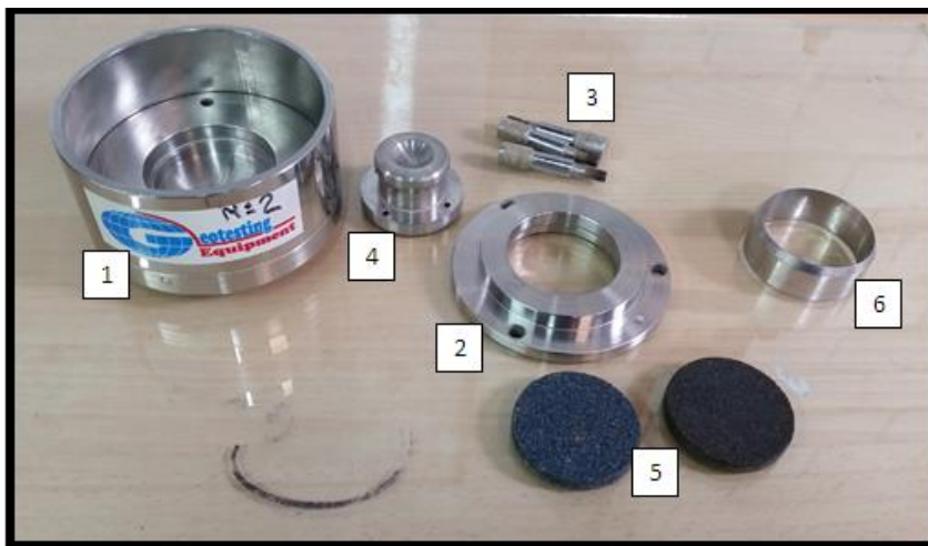
Imagen 17 Equipo de Consolidómetro.
