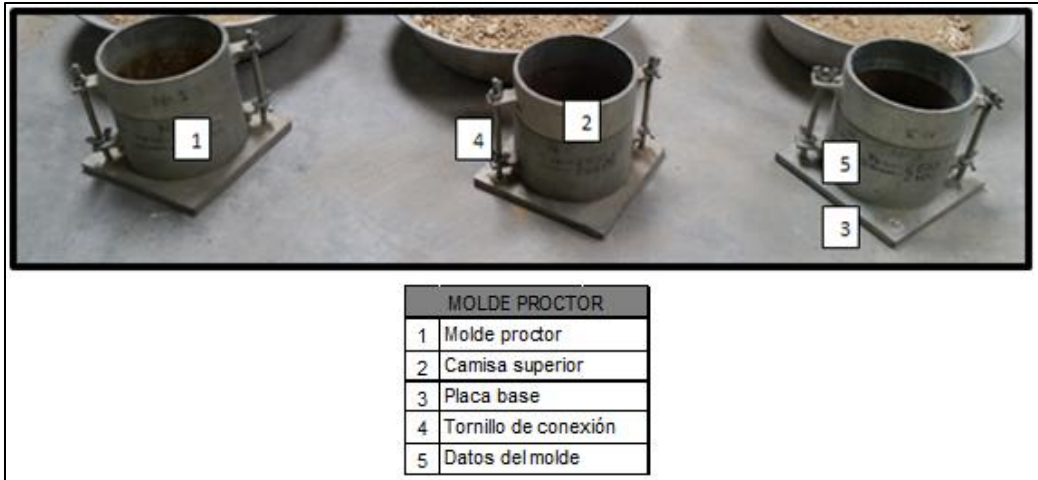
Imagen 43 Moldes de Compactación
