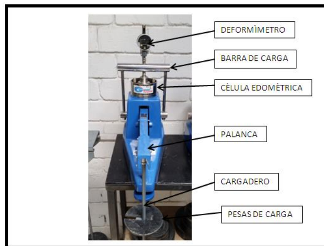
Imagen 16 Consolidómetro para ensayo de Consolidación Unidimensional
