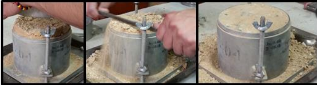
Imagen 48 Enrasado de muestra compactada
