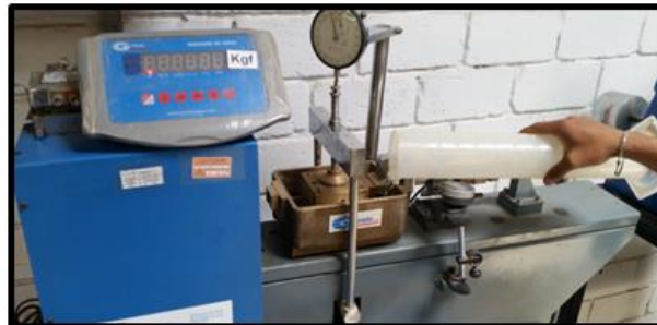
Imagen 37 Inundación de caja de corte
