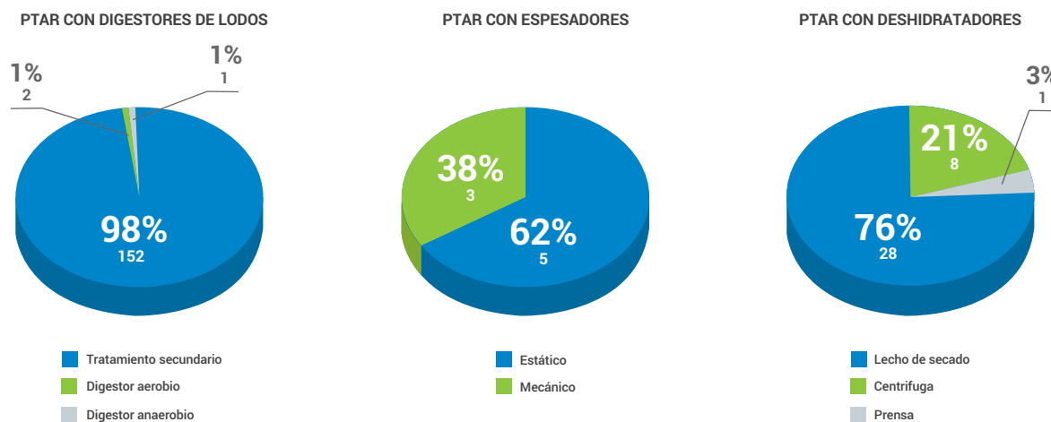
Figura 32: Equipos utilizados para la deshidratación de lodos en las PTAR
