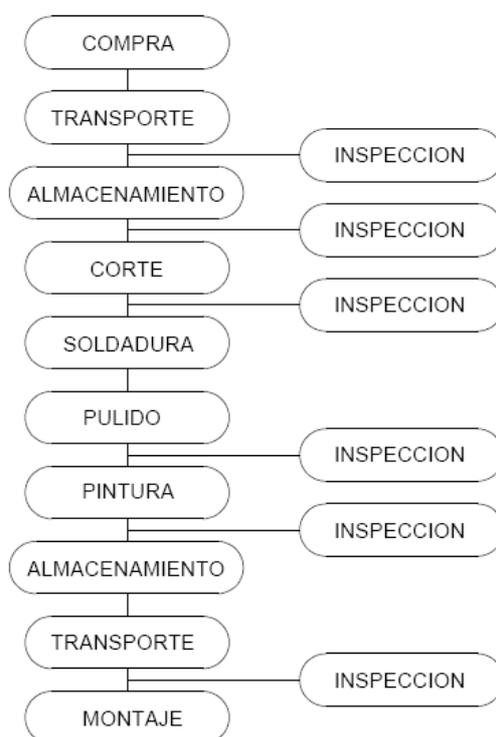
**Figura 5.16 Diagrama de flujo del proceso de prefabricación.**
