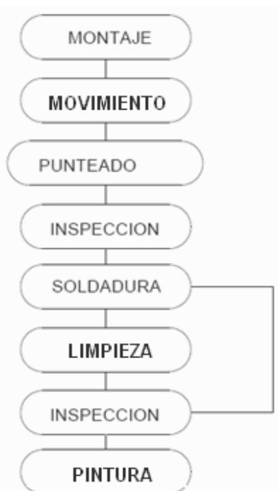
Figura 5.21 Diagrama de flujo del proceso de montaje
