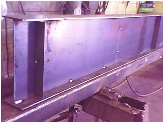
Figura 5.17 Viga armada.
