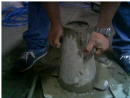
Figura 4. Retirando el molde del concreto
