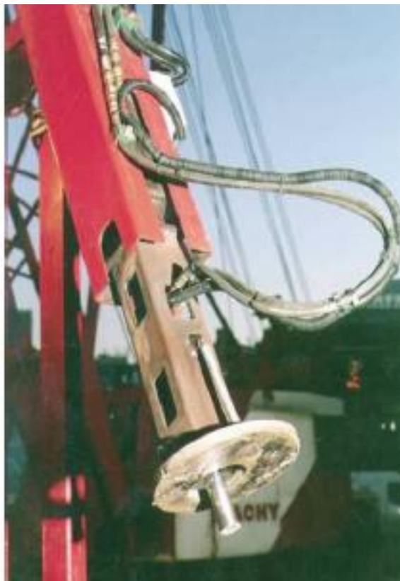
Fig 4.6, Equipo para la inspección del fondo de las pilas y campanas
