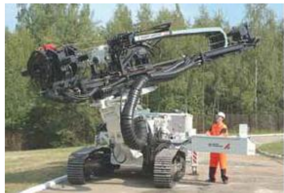
Fig 3.3, Equipos para perforación sónica; montado sobre camión, y montado sobre orugas
