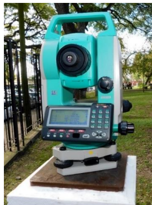
Estación total integrada (convencional).
