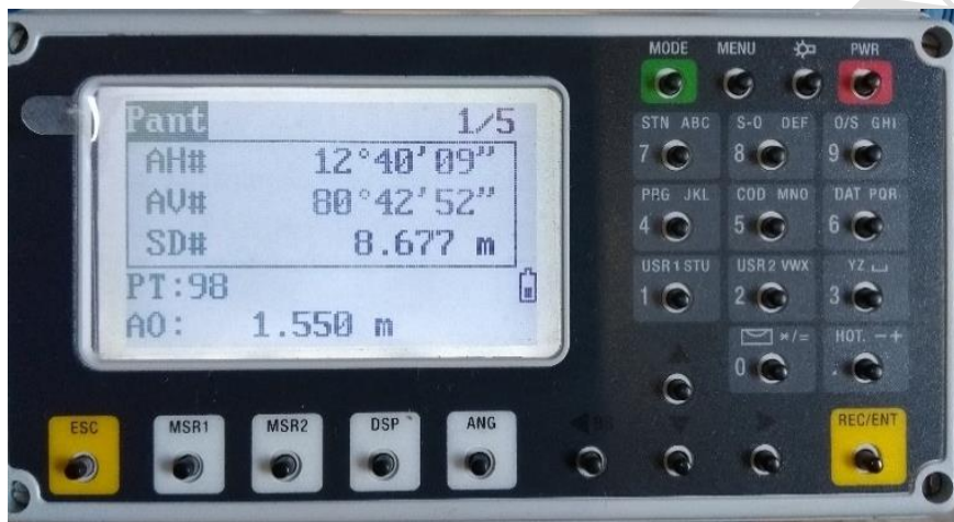
Taquimetría común con estación total Spectra Focus 2. AH#: dirección medida al punto de interés en CI. AV#: ángulo cenital medido al punto de interés en CI. SD#: distancia inclinada medida al punto de interés. AO: altura de la señal (prisma).
