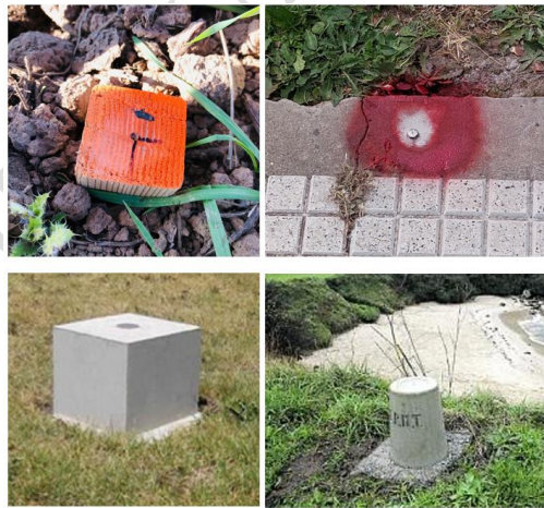
Algunos tipos de puntos que pueden conformar una red planialtimétrica.
