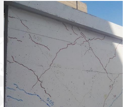
Figura 4.20. MDL02-SCA-LR: Fase 10 – amplitud: 12.00 mm.
