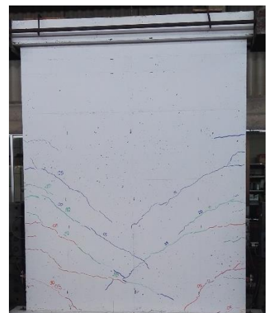
Figura 4.27. MDL03-SCA-LR: Fase 07 – amplitud: 4.50 mm.
