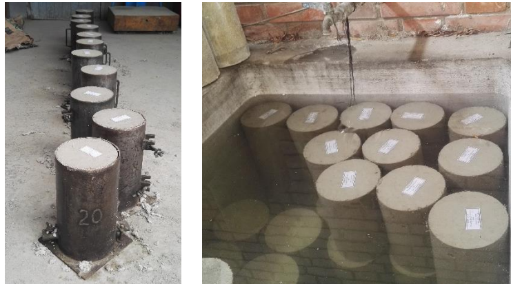
Figura 3.3. Izq. Probetas de concreto. Der. Curado de probetas de concreto en poza del laboratorio.
