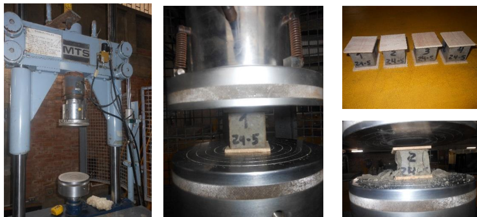
Figura 5.16. Ensayo de compresión de cubos de mortero.
