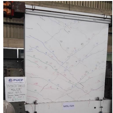
Figura 6.28. MDL02-R-SCA: Fase 13 – amplitud: 30.50 mm.
