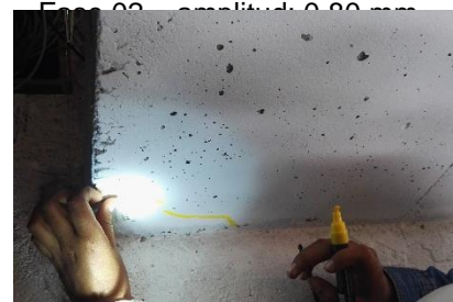
Figura 4.3. MDL01-SCA-LR: Fase 03 – amplitud: 1.00 mm.
