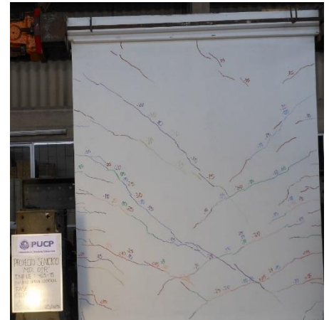
Figura 6.25. MDL02-SCA-LR: Fase 10 – amplitud: 12.00 mm.
