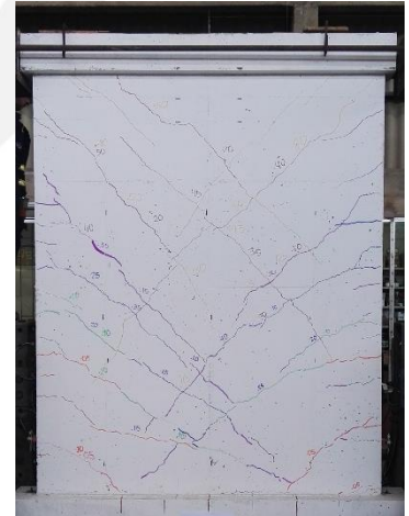
Figura 4.30. MDL03-SCA-LR: Fase 10 – amplitud: 12.00 mm.
