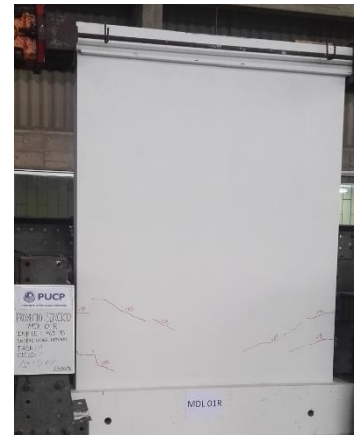
Figura 6.4. MDL01-R-SCA: Fase 04 – amplitud: 1.50 mm.
