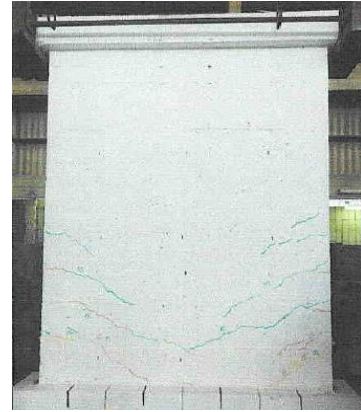
Figura 4.16. MDL02-SCA-LR: Fase 06 – amplitud: 3.00 mm.
