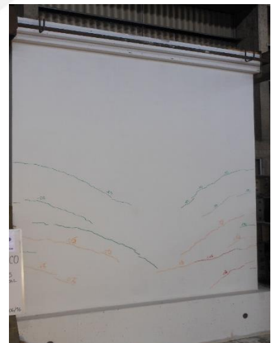
Figura 6.6. MDL01-R-SCA: Fase 06 – amplitud: 3.00 mm.
