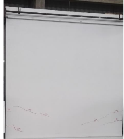
Figura 6.19. MDL02-R-SCA: Fase 04 – amplitud: 1.50 mm.
