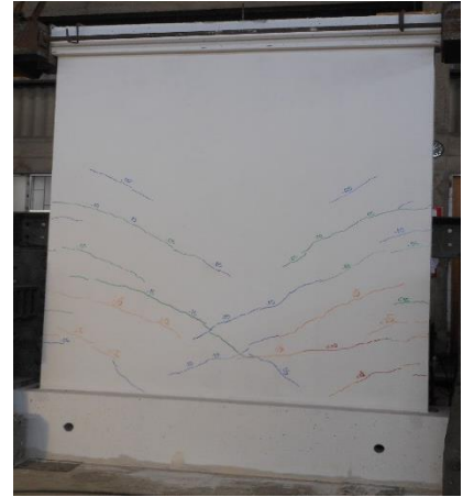
Figura 6.37. MDL03-R-SCA: Fase 07 – amplitud: 4.50 mm.
