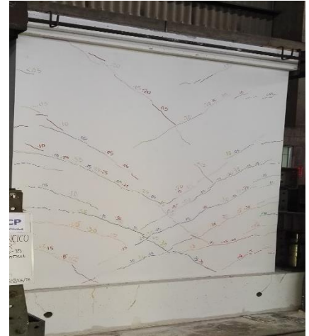
Figura 6.40. MDL03-SCA-LR: Fase 10 – amplitud: 12.00 mm.
