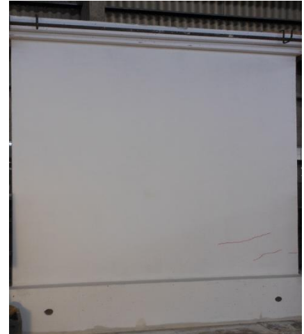
Figura 6.34. MDL03-R-SCA: Fase 04 – amplitud: 1.50 mm.
