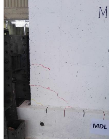
Figura 4.4. MDL01-SCA-LR: Fase 04 – amplitud: 1.50 mm.
