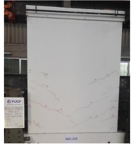
Figura 6.7. MDL01-R-SCA: Fase 07 – amplitud: 4.50 mm.
