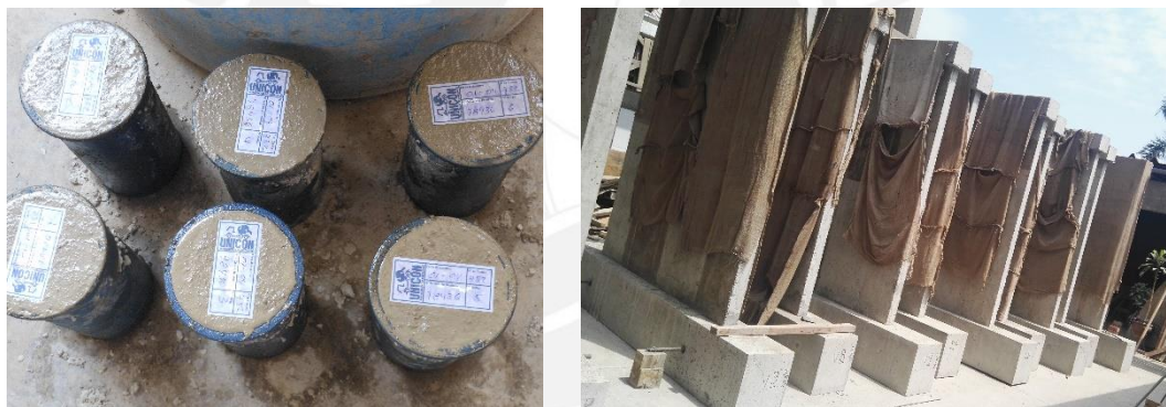
Figura 3.20. Izq. Probetas de concreto UNICON. Der. Curado de los 09 MDL
