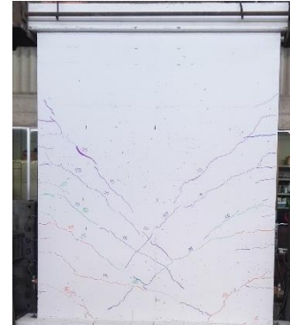
Figura 4.28. MDL03-SCA-LR: Fase 08 – amplitud: 6.00 mm.
