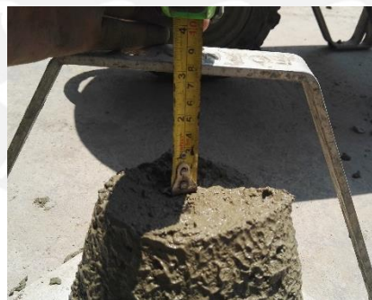
Figura 3.2. Ensayo de medición de slump utilizando el cono de Abrahams
