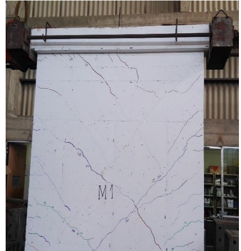
Figura 4.10. MDL01-SCA-LR: Fase 10 – amplitud: 12.00 mm.
