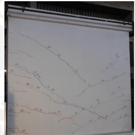
Figura 6.23. MDL02-R-SCA: Fase 08 – amplitud: 6.00 mm.
