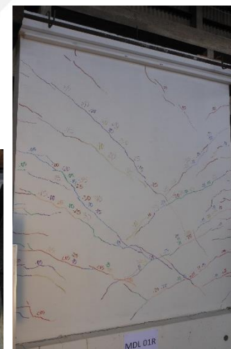
Figura 6.12. MDL01-R-SCA: Fase 12 – amplitud: 23.50 mm.
