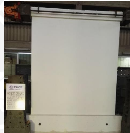
Figura 6.32. MDL03-R-SCA: Fase 02 – amplitud: 0.80 mm.
