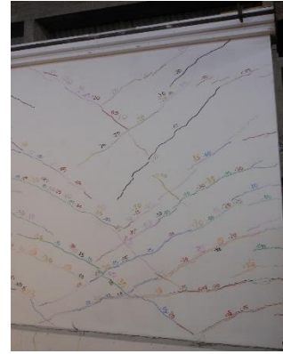
Figura 6.13. MDL01-R-SCA: Fase 13 – amplitud: 30.50 mm.
