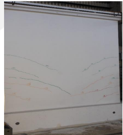
Figura 6.21. MDL02-R-SCA: Fase 06 – amplitud: 3.00 mm.
