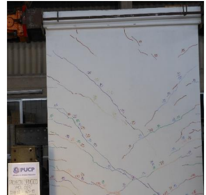
Figura 6.10. MDL01-SCA-LR: Fase 10 – amplitud: 12.00 mm.
