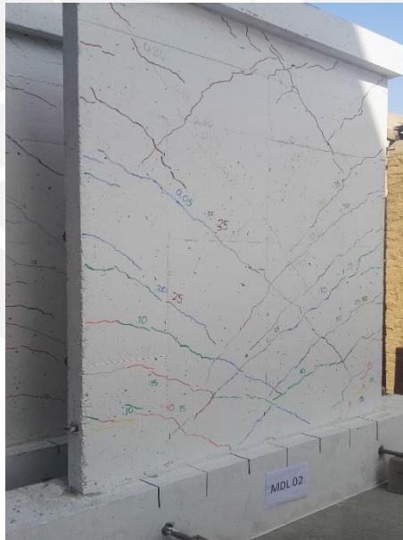
Figura 5.1. MDL02 al finalizar el ensayo hasta el límite de reparabilidad.
