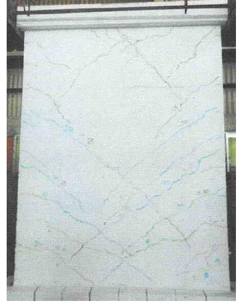
Figura 4.19. MDL02-SCA-LR: Fase 09 – amplitud: 8.50 mm.
