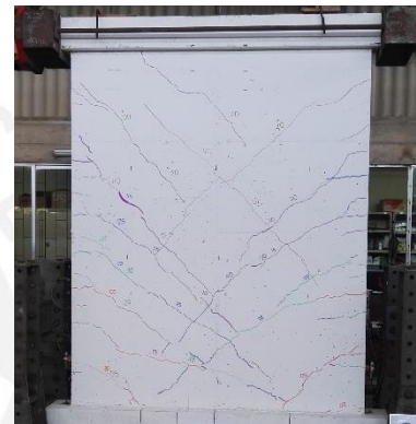
Figura 4.29. MDL03-SCA-LR: Fase 09 – amplitud: 8.50 mm.
