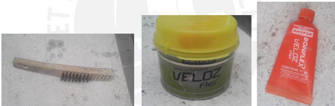
Figura 5.3. Elementos utilizados para la delineación de fisuras.
