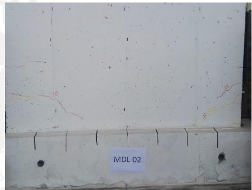
Figura 4.14. MDL02-SCA-LR: Fase 04 – amplitud: 1.50 mm.
