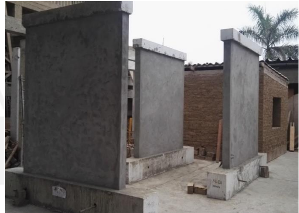
Figura 5.17. Esquema de variación en planta de los MDL reparados y reforzados y disposición de los MDL listos para ser ensayados.
