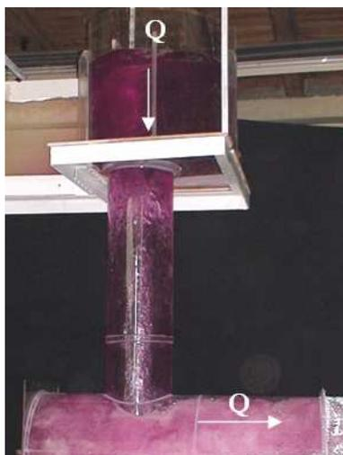
**Fotografía No. 5.4:** Tubo vertical en el DV con aproximación subcrítica.
