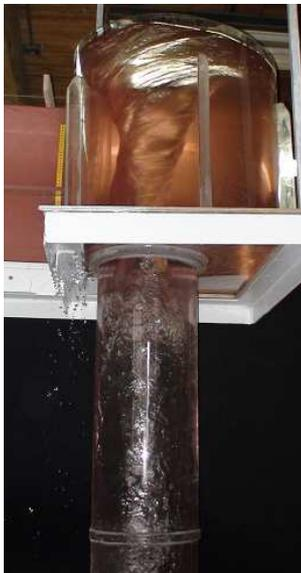
**Fotografía No. 3.8:** Desplazamiento hacia la izquierda del núcleo de aire en la cámara de entrada.
