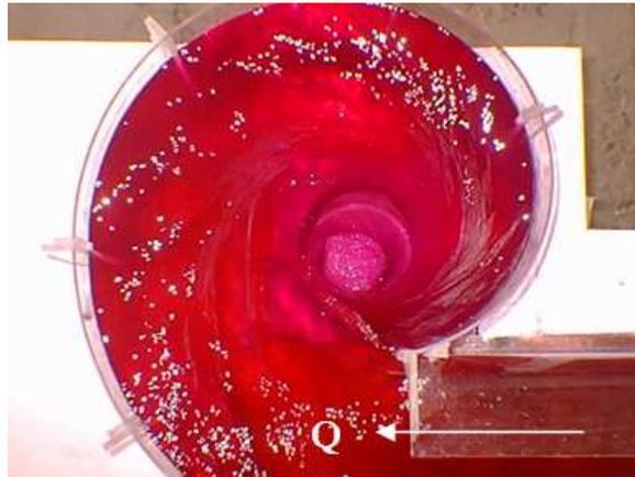
**Fotografía No. 5.2:** Vista superior de la cámara de entrada del DV para flujo subcrítico.
