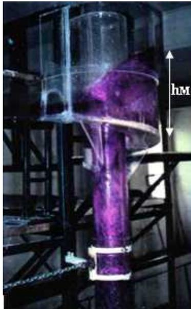
**Fotografía No. 5.5:** Tubo vertical en un descargador a vórtice con aproximación supercrítica.
