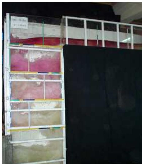
**Fotografía No. 4.1:** Pozo de Bandejas Reja-Orificio.
