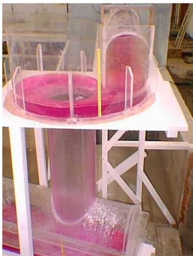
**Fotografía No. 2.3:** Descargador a vórtice.
