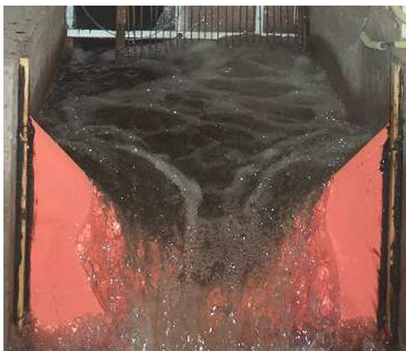
**Fotografía No. 4.8:** Flujo en la descarga para el pozo de bandejas reja - orificio.
