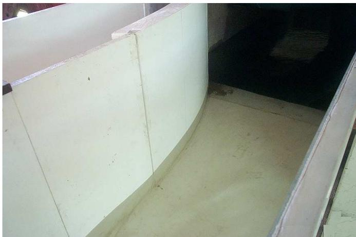
**Fotografía No. 4.3:** Transición con paredes de alineación curva.
