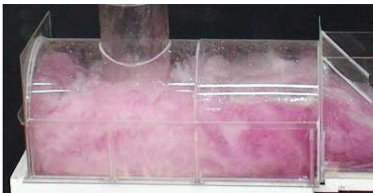
**Fotografía No. 3.10:** Formación del colchón de aguas y presencia de la masa agua - aire en la cámara de disipación para caudales altos.
