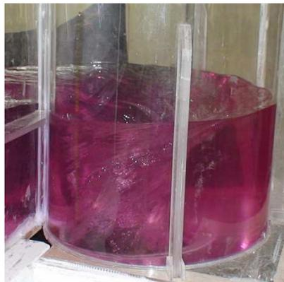
**Fotografía No. 3.7:** Formación del núcleo de aire en la cámara de entrada.
