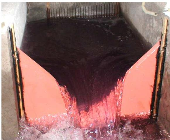
**Fotografía No. 4.9:** Flujo en la descarga para el pozo de bandejas con reja.
