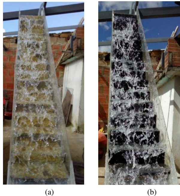
Figura 7. Régimen de flujo saltante en los dos modelos hidráulicos de canal escalonado (a) en concreto y (b) revestido en neumático usado, para caudal máximo (1.28 l/s). Fuente: [9]
