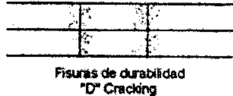
Figura 5.5. Fisuras de durabilidad
