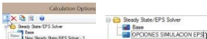
Seguidamente en la ventana Propiedades, cree un cálculo en Periodo Extendido (EPS) que inicie a las 12:00 AM, con 24 horas de duración y un paso hidráulico de 1 hora.
