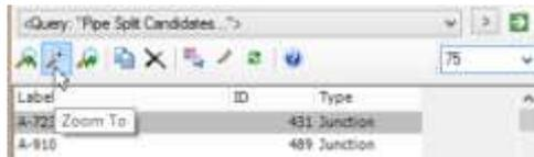
Ajuste el zoom a 75% y seleccione una tubería y luego presione el botón **Zoom to**. Si le estorba la ventana de Network Navigator, arrástrela a un lado para que pueda ver los nodos.
