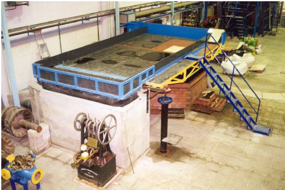
Figura 2: Plataforma de ensayo para rejas e imbornales
