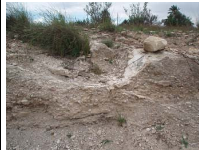
38 Costra calcárea rosada bien cementada en el PK 7+800.
