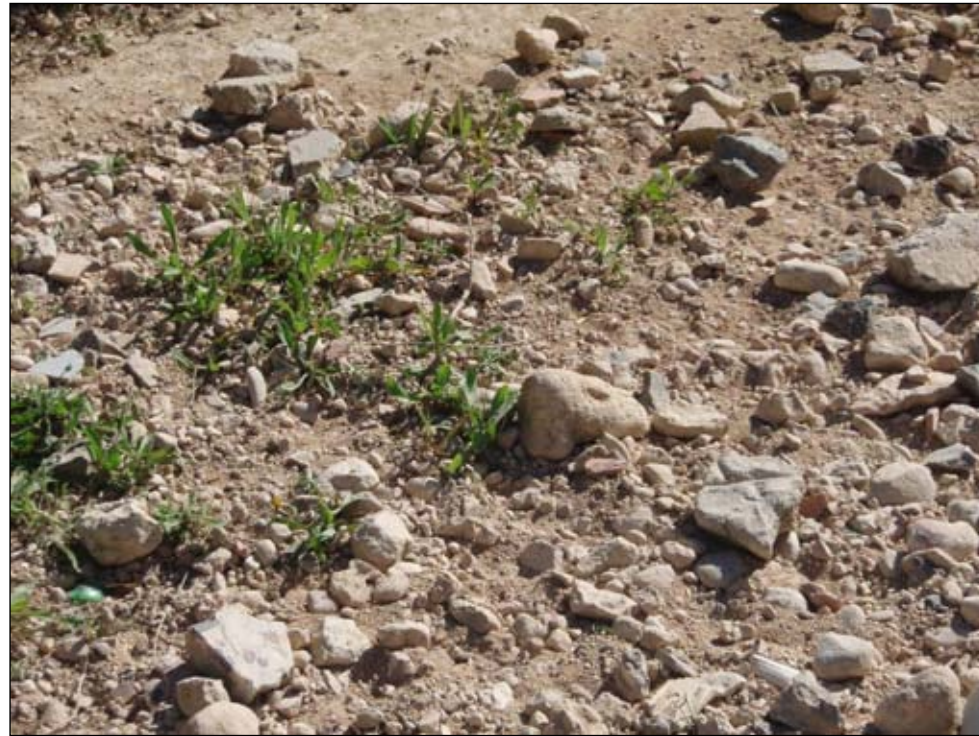
FIGURA 22. BOLOS Y GRAVAS REDONDEADAS EN MATRIZ ARENO-LIMOSA SUELTA.
