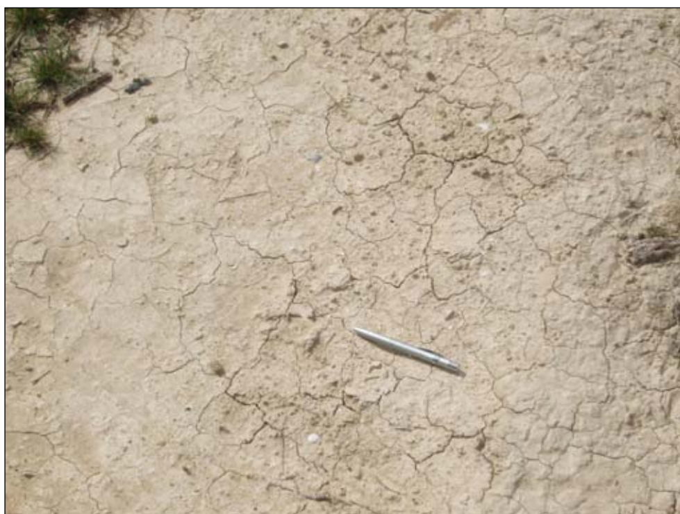
FIGURA 21. LIMOS ARCILLOSOS OCRES ALGO PLÁSTICOS
