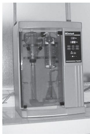
Figura P8.2: Módulo de destilación
