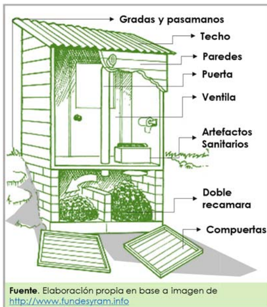
Figura 04. Partes de una letrina abonera
