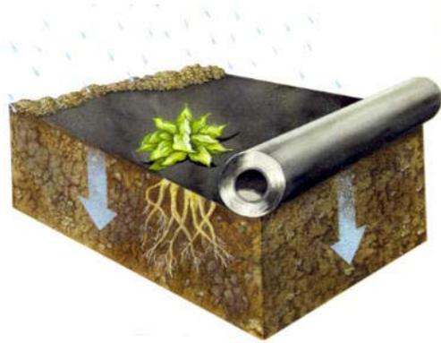
Detalle de cómo la semilla germina y posteriormente atraviesa la cubierta del manto (TRM) para salir a la superficie.
