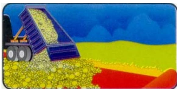
5. se esparce el material de relleno sobre el Geotextil con una primera capa compactada de 15 cm. En caso de subrasantes muy blandas se compacta ligeramente las dos primeras capas.
