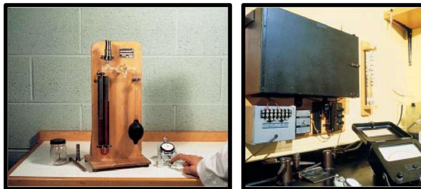
Figura 2.3 y 2.4 Aparato de Blaine (izquierda) y turbidímetro de Wagner (Derecha) para la determinación de la finura del cemento.
