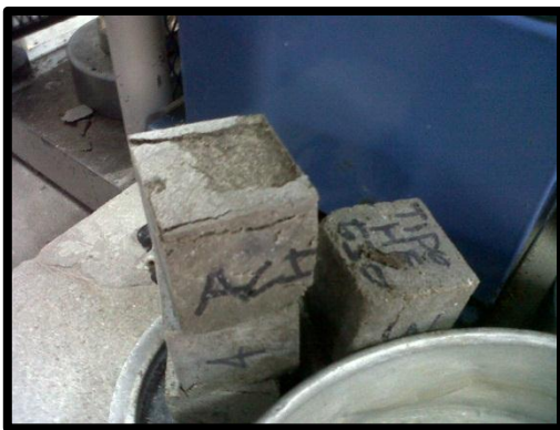
Figura 4.7 Cubos de mortero hidráulico sometidos a ensayo de compresión.
