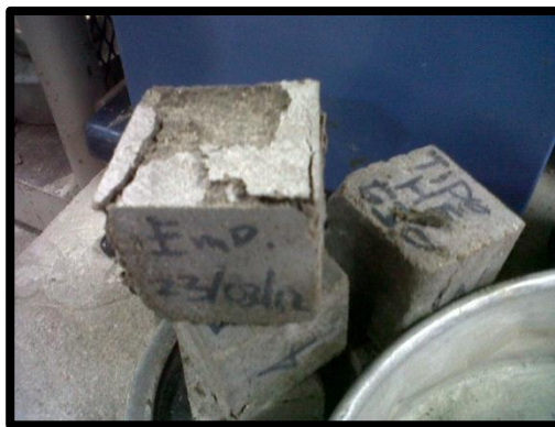
Figura 4.7 Cubos de mortero hidráulico sometidos a ensayo de compresión.
