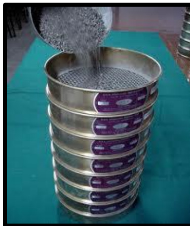
Figura 2.14 Análisis granulométrico de agregados ASTM C-136.
