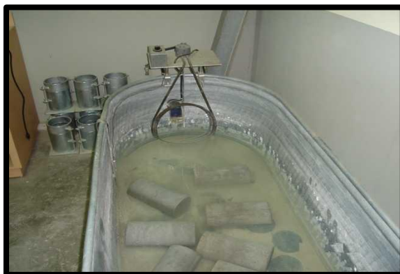
Figura 2.25 Curado de especímenes de concreto.
