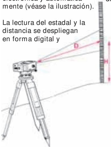
además se pueden registrar; las alturas del estadal se calculan continuamente, por lo que se elimina la posibilidad de errores en la lectura, en el registro y el cálculo. Leica Geosystems ofrece también programas para el post-proceso de los datos registrados.
