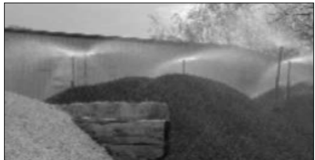
Aspersión ( humedecimiento ) de los agregados en su sitio de almacenamiento
